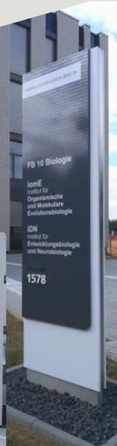
1 Stele aus Aluminium Größe 3.200x1.400x380mm mit ausgedupelter Leuchtschrift
