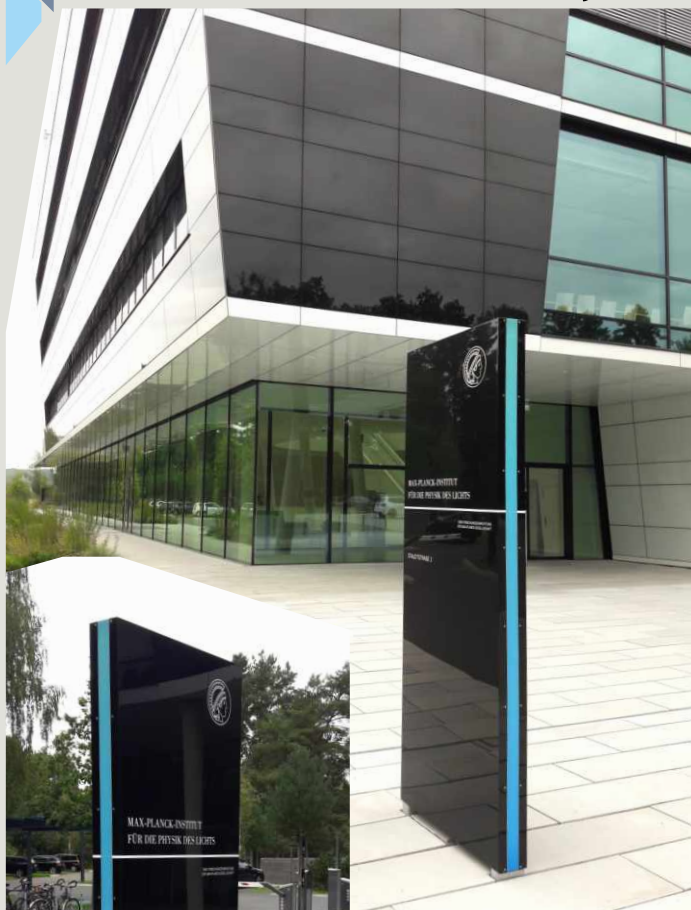
1 Außenstele aus Aludibond mit innenliegender Stahlkonstruktion Seiten aus bedruckten Acrylglas ausgeleuchtet mittels LED Größe 2.500x900x150mm
